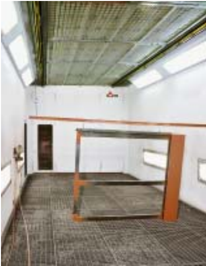
Beide Lackierkabinen können als Großraumkabine für die Beschichtung langer Bauteile zusammengesaltet werden. Fotos: M. Rehm
